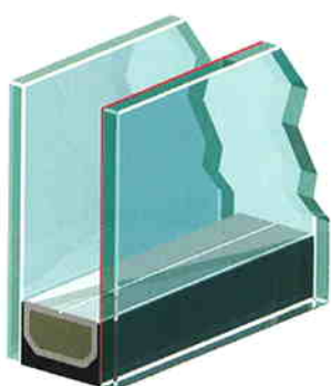
Vitrage à faible émissivité 4/16 argon / 4 ITR
